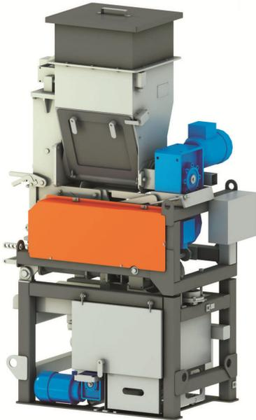
Автоматическая дробильно-сократительная машина **АДСМ-3-25М** предназначена для измельчения проб каменных и бурых углей, антрацитов, горючих сланцев и продуктов их обогащения, последующего сокращения и деления измельченного материала на равновеликие и равноценные по качеству части (дубликаты).
