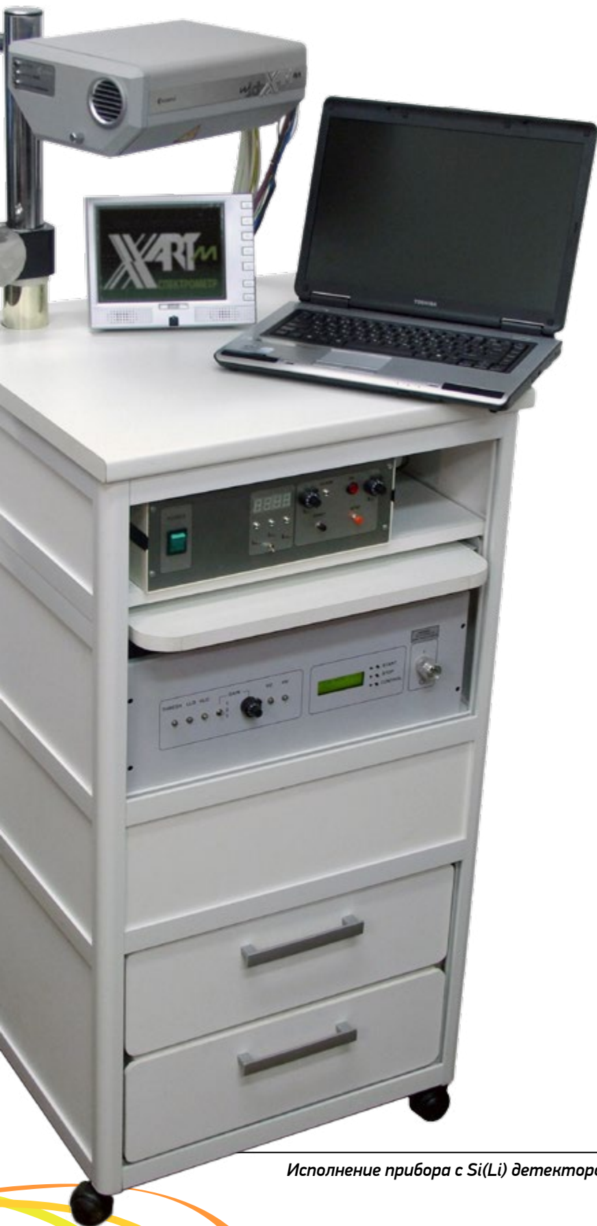
Si(Li) блок детектирования с системой электромашинного охлаждения
